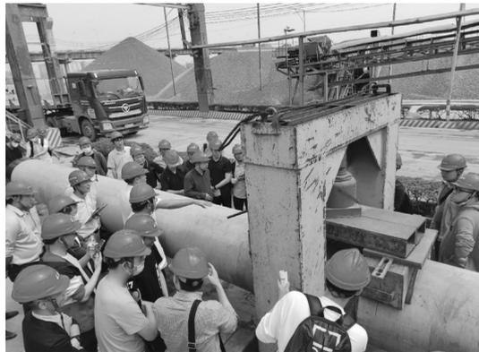
图 2 PRC 管桩焊接接头载荷试验
